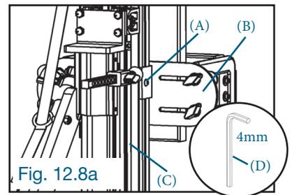
Ajustement en largeur (Fig. 12.8b)
